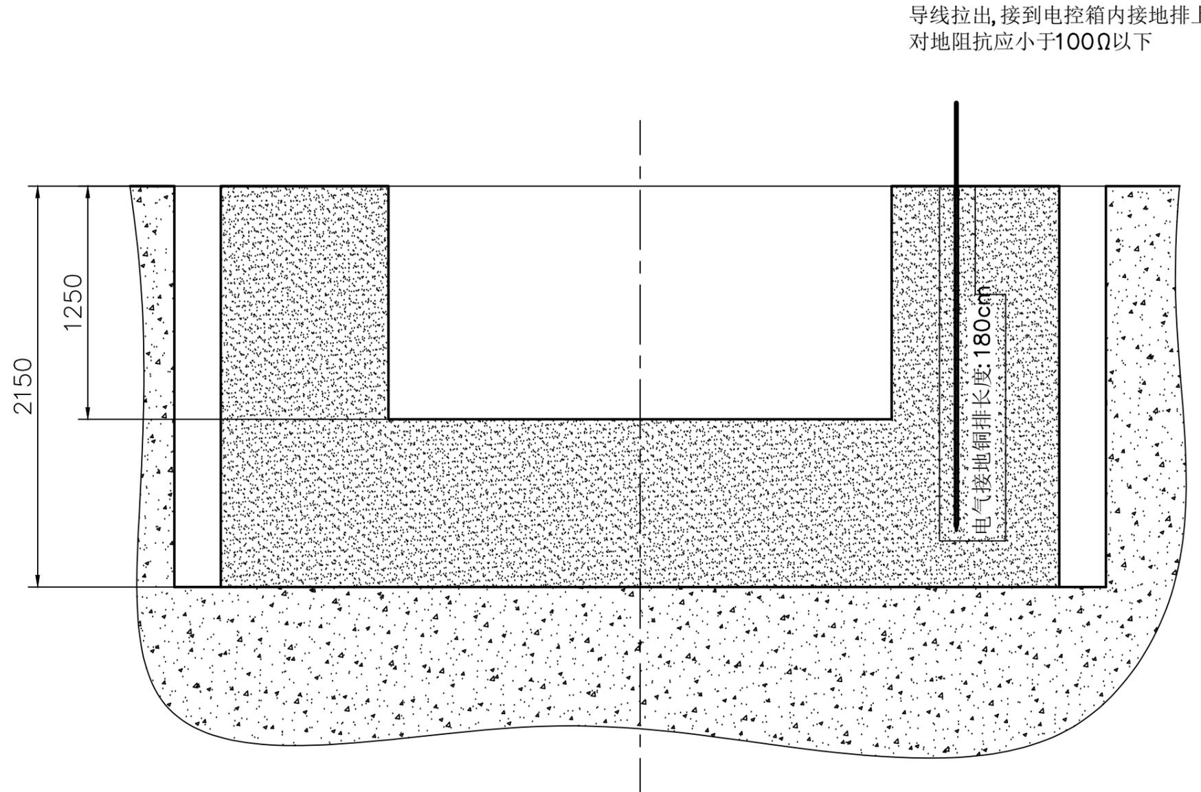
导线拉出, 接到电控箱内接地排上.
